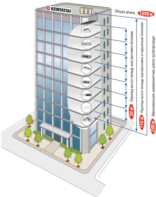
Применение новых технологических и конструкторских решений позволило увеличить максимально допустимые длины трубопроводов и перепад высот между блоками. Теперь можно предложить больше вариантов размещения наружных и внутренних блоков, систему можно устанавливать в более высоких зданиях. Можно значительно увеличить площади кондиционирования.
