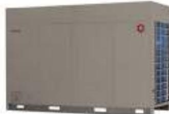
■ Линейка наружных блоков типа KTRZ-HZAN3-B представлена семью моделями: 56.0, 61.5, 67.0, 73.0, 78.5, 85.0, 90 кВт. В зависимости от мощности, к одному наружному блоку можно присоединить максимально от 33 до 53 внутренних блоков. Суммарная длина трубопровода хладагента составляет 1000 м, максимальная длина от наружного блока до
